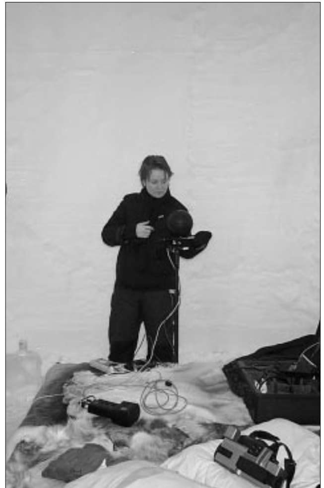
FIGUUR 2: HET METEN VAN DE BINNENCONCENTRATIE CO 2 TER BEPALING VAN HET VENTILATIEVOUD VAN EEN HOTELKAMER EN HET VERLOOP VAN DE ALDAAR AANWEZIGE CONCENTRATIES CO 2 -GAS. EEN REDEN VOOR HET UITVOEREN VAN DEZE METINGEN WAS DE AFWEZIGHEID VAN EEN MECHANISCH VENTILATIESYSTEEM. DE VRAAG WAS OF ENKEL EEN NATUURLIJKE WIJZE VAN VENTILATIE VOLDEED.
